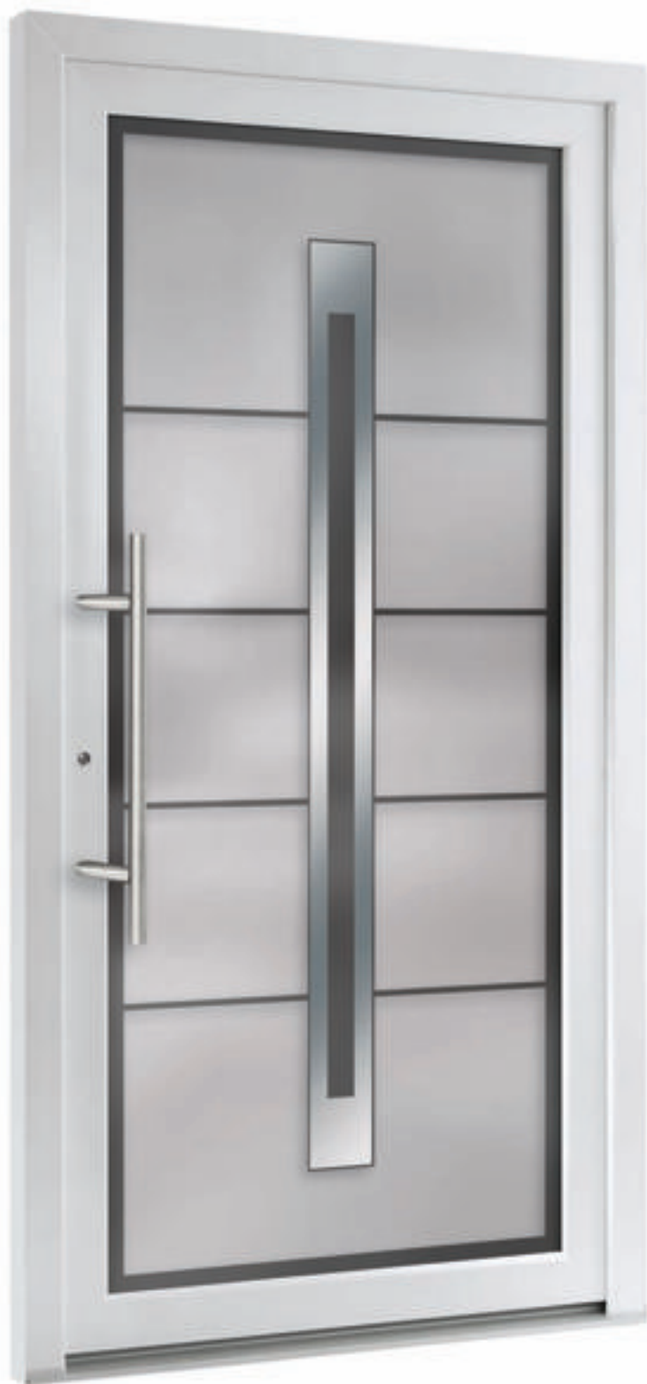
Modell 6272-07 | 3-fach Verglasung: mittlere Scheibe ESG | mattiertes Glas mit klarem Rand, Motiv und Streifen klar | Applikation – Edelstahl | Griff: 9023-13 Edelstahl
